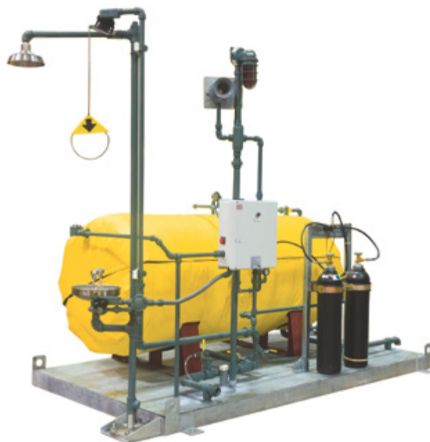
Unité de 400 gallons / 1 514,2 litres, entraînée par air, réservoir horizontal, pomme de douche et buses de pulvérisation de la douche oculaire en acier inoxydable, témoin d'alarme lumineux et sonore
