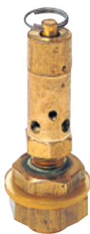
Modèle 01105001 Vanne de surpression de 115 lb/po² avec anti-retour pour unités autonomes portatives
