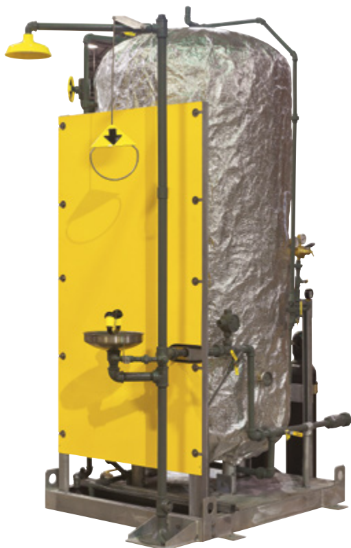
Unité de 400 gallons / 1 514,2 litres entraînée par air, douche d'urgence et douche oculaire, cloison grise avec revêtement anticorrosion, cuvette de la douche oculaire en acier inoxydable, couvercle de réservoir thermoréfléchissant, installation sur patins
