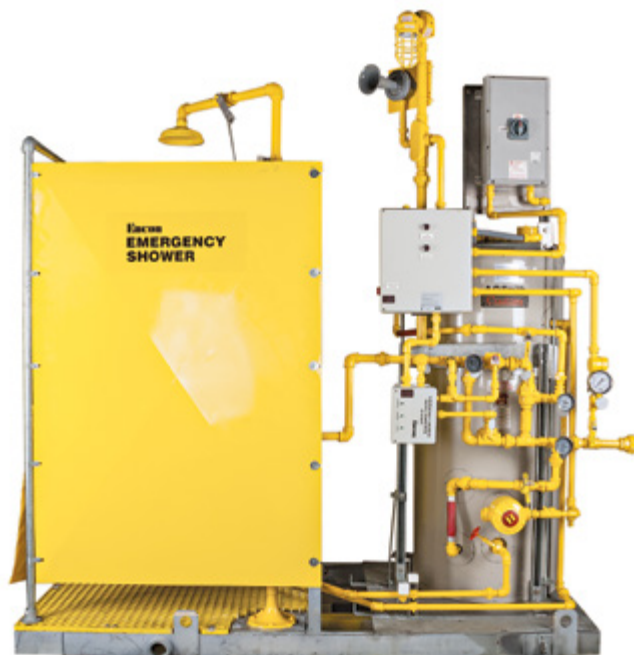
Unité de 120 gallons / 454,2 litres avec mitigeur électrique d'une capacité de 30 gpm / 113,6 lpm, revêtement anticorrosion jaune, alarme de sécurité, installation sur patins
