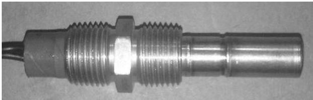
**Figura 4-15. Termostato del calentador de la cabina**
